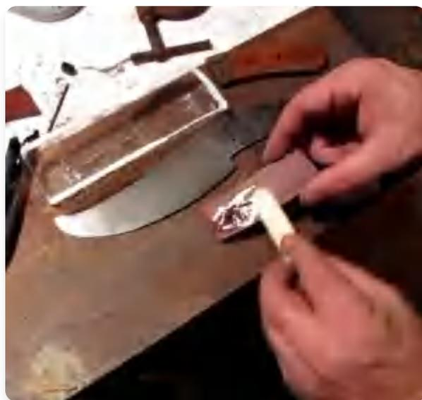
混合两部分环氧树脂胶，比如五分钟大猩猩胶(Gorilla glue)。不过，你也可以使用二十分钟的环氧树脂胶，这样有更多时间正确安装刀。
