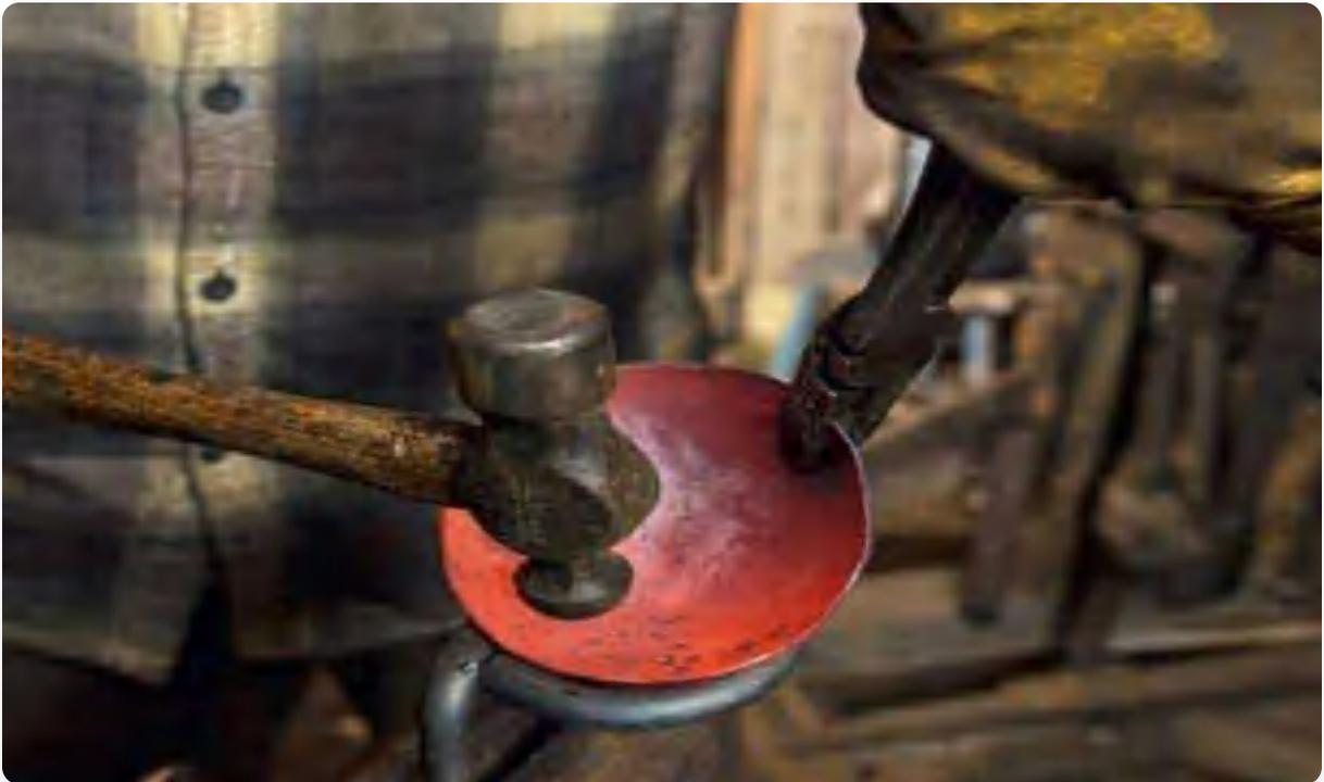
使用成型工具隔离出钢条端部的 $\frac{3}{4}$ 英寸，然后将其打圆。将颈部向后锥化3英寸。用横锤敲击端部形成椭圆形，其宽边与手柄轴垂直。继续弯曲椭圆形端部以适应碗的曲线。
