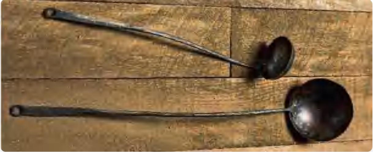
您需要16号金属薄板或6英寸×6英寸、8英寸圆钢拉长，或10号铜线。对于蛋勺，在金属板上画一个6英寸的圆并使用冷切割磨床或凿子将其切出。对于长柄勺，制作一个4到5英寸的圆。使用锉刀或磨床清理边缘。
