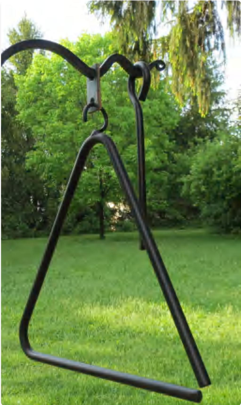
餐铃是新手铁匠可以制作的最简单的物品之一，三角形餐铃是一个很好的起点。拿一小块薄金属片。加热并将其弯成三角形。再拿另一块薄金属片，锻造出一个小铃舌(clinger)。
