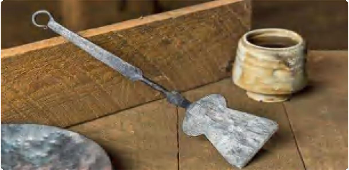
传统锅铲是练习锤击技术的绝佳方式。您需要4英寸×1英寸的钢材。从一端1 $\frac{3}{4}$ 英寸处锻造肩部。在砧的近侧用半面锤击并锻造隆起。从第一个肩部 $\frac{3}{4}$ 英寸处在 $\frac{1}{4}$ 英寸面上收颈。
