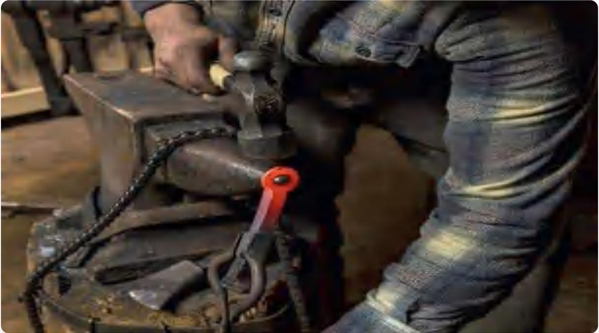
加热一块金属并使用半面锤击将前1英寸压平。同时，确保将钉头上突出的边缘定向，使尖端处形成的肩部位于开瓶器的对面。这样做会使最终产品更加符合人体工程学。
