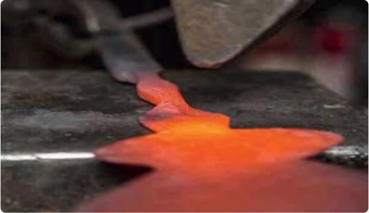
使用半面锤击；从手柄顶部 $\frac{3}{4}$ 英寸处偏置，这就是挂钩。从圆筒向后在手柄背面制作浅凹槽。将偏置部分锻造成尖并向偏置方向制作小卷曲。之后，淬火卷曲部分并用砧角闭合环。在卷曲之前将偏置加热到20至30度以形成圆环。
