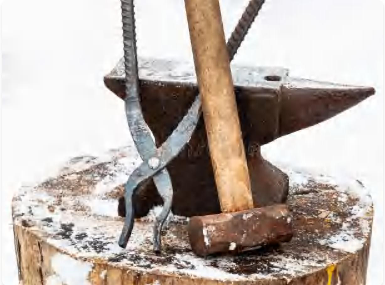
要制作钳子，你需要一块薄金属片、一把锤子、一个锻炉、管钳或锁紧钳、一个铁砧、一根用于螺栓的杆和一个斧头或凿子。
