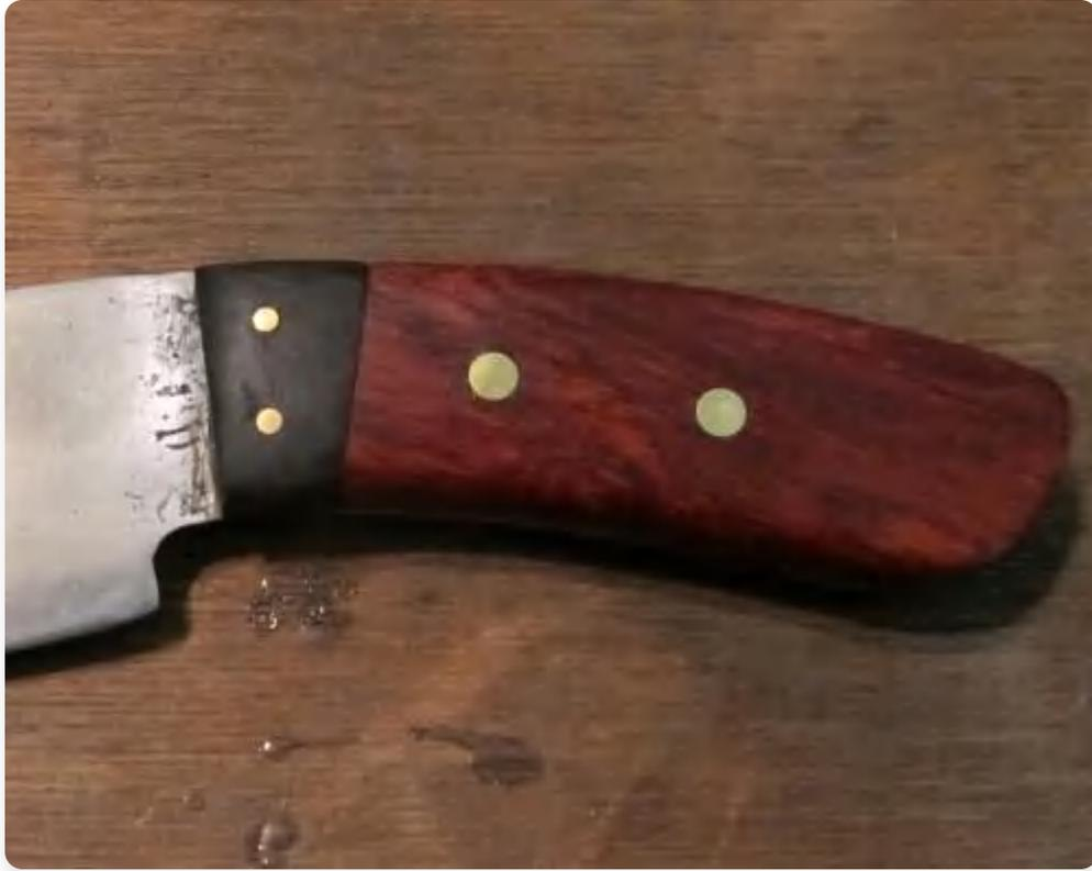
刀柄有两个不同的部分：护手(bolster)，即深色木头，和刀柄，即浅色木头。因此，刀柄有四块，每侧两块。您 will 用胶水将这四块固定到位，并用黄铜销钉固定。刀柄中的黄铜杆是1/8英寸，而护手是1/16英寸，如下所示。
