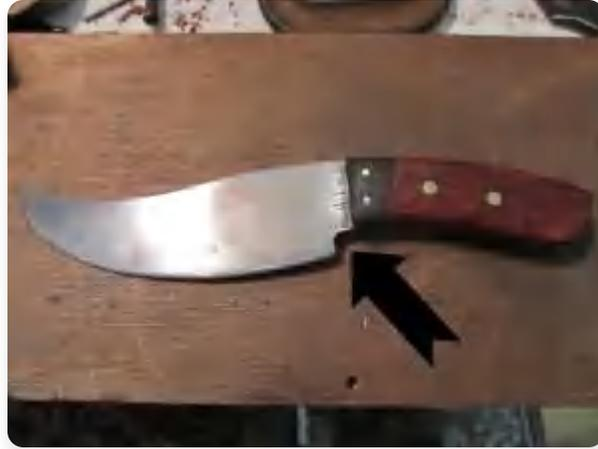
确保在开始锻造刀具时雕刻出落差护手。您可以在开始弯曲之前做这个，我们称之为半面锤打(half-face hammering)，这是通过将刀具一半放在铁砧外来完成的。
