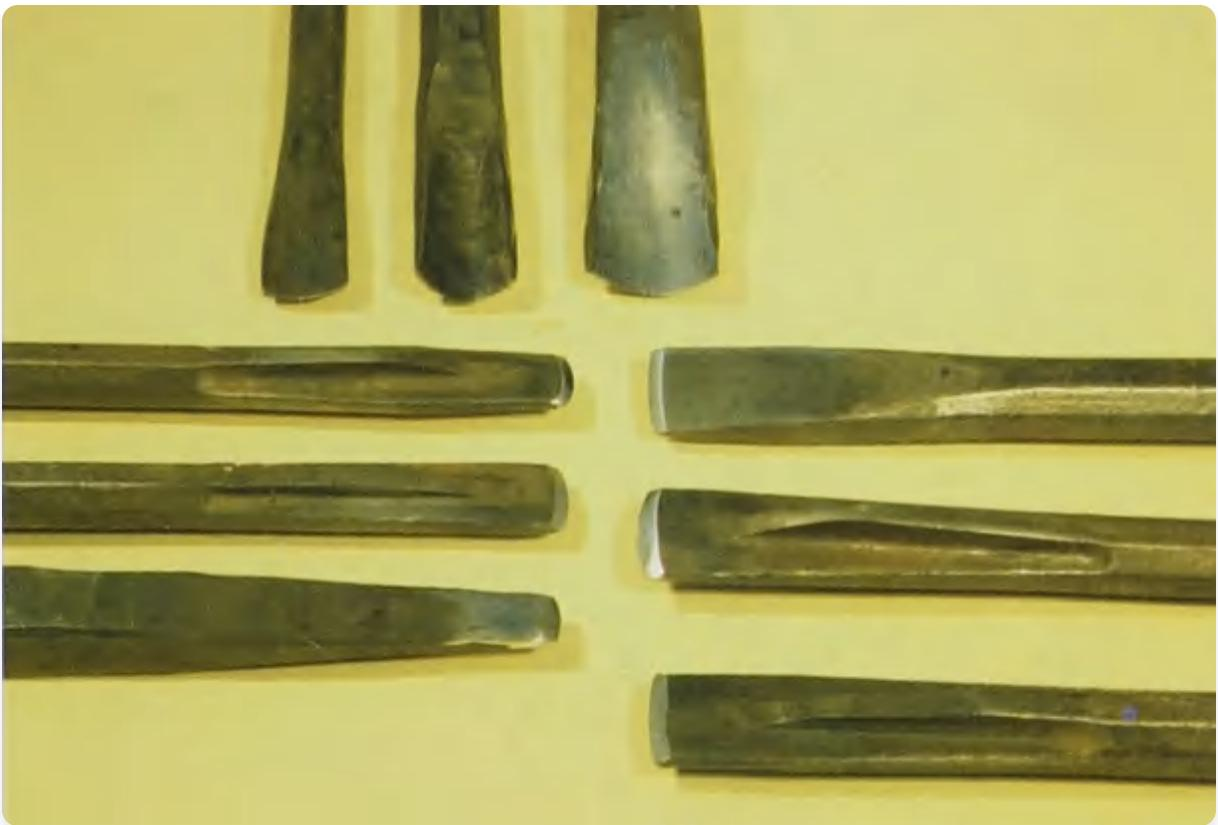
手工凿子;(上)弯曲凿子;(下)直凿子,部分由建筑工人用的星形钻头改制而成。
