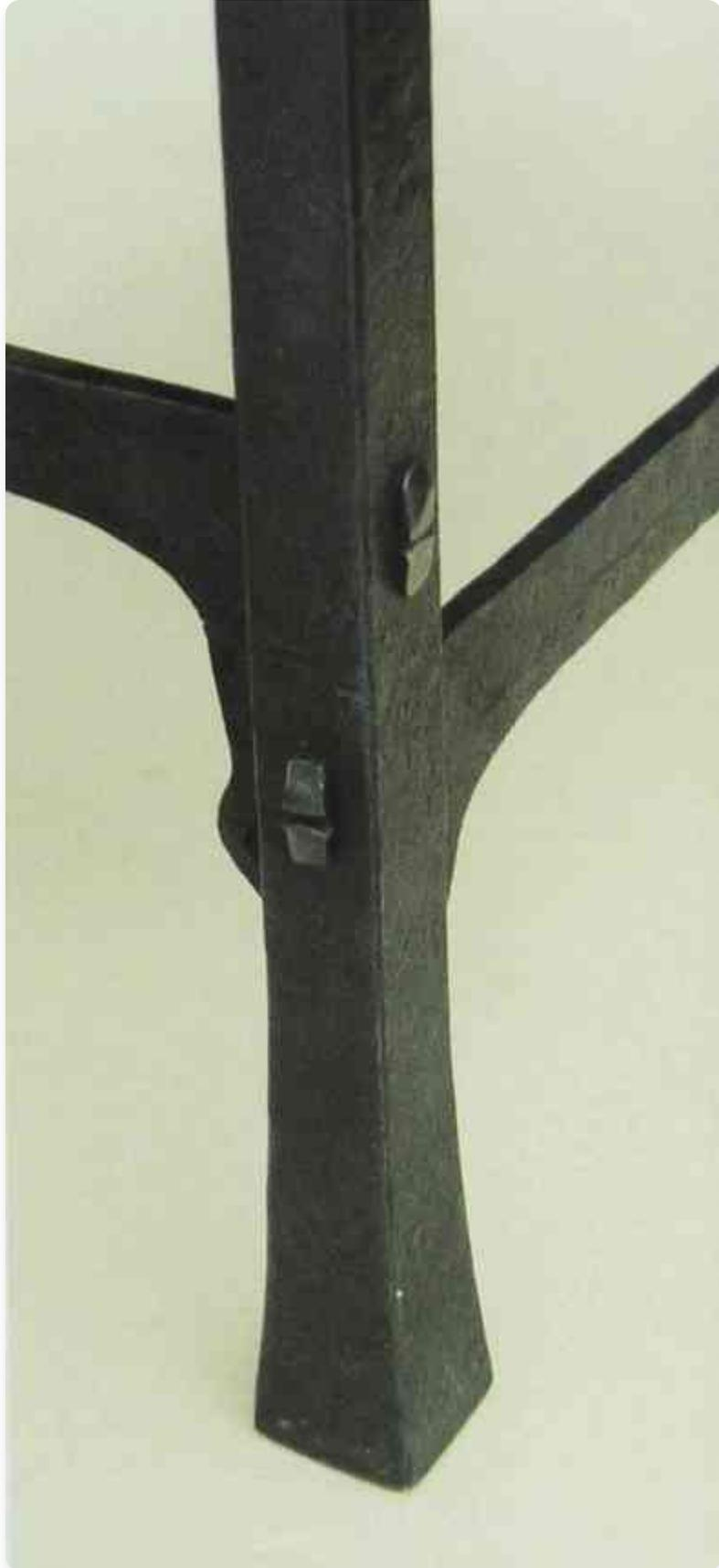
作者制作的咖啡桌腿,显示25mm(1英寸)棒材通过在块上敲打进行镦粗。
