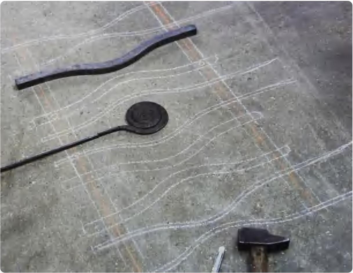
在混凝土工坊地板上布置的围栏设计。
