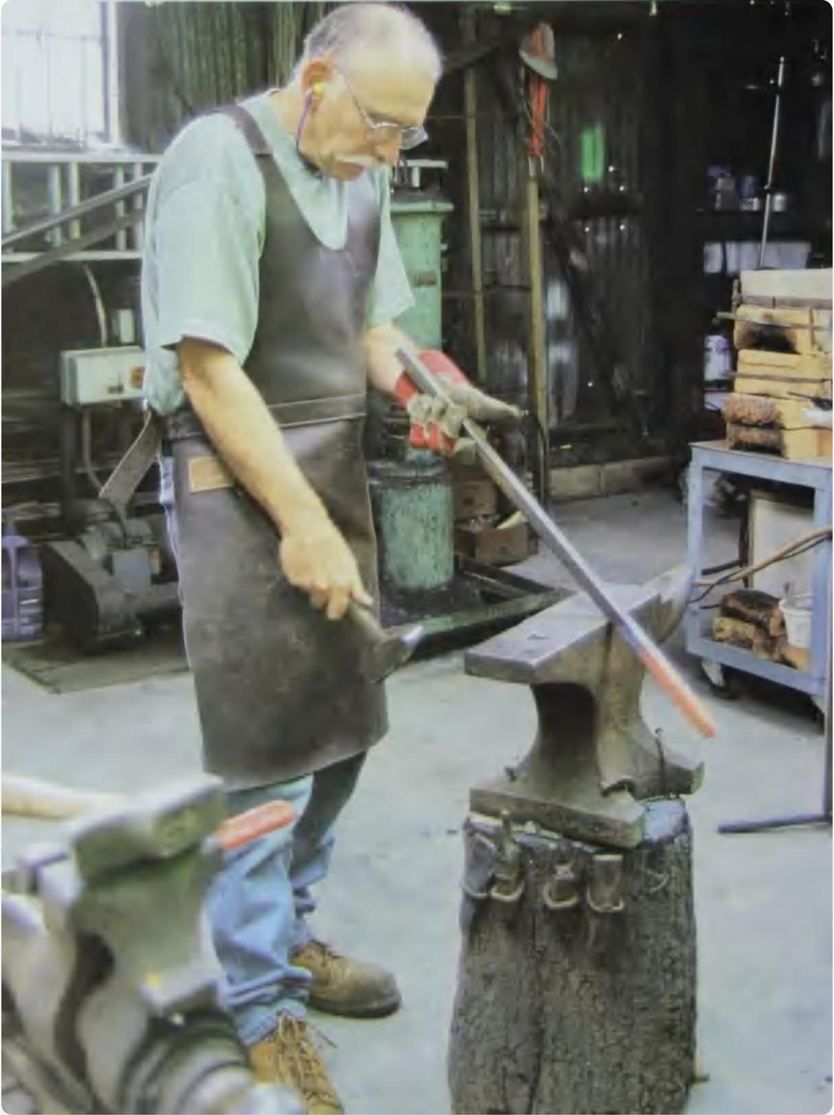
检查金属条的平直度。注意防护服——眼睛和耳朵防护、皮革围裙、手套和安全靴。还要注意固定在砧座上的各种砧工具。
