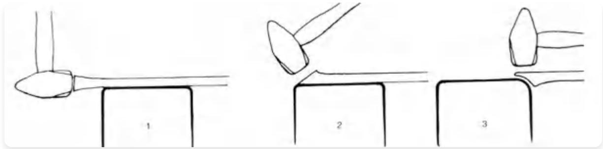
为火焊准备斜面接头(scarfing)的金属条。
