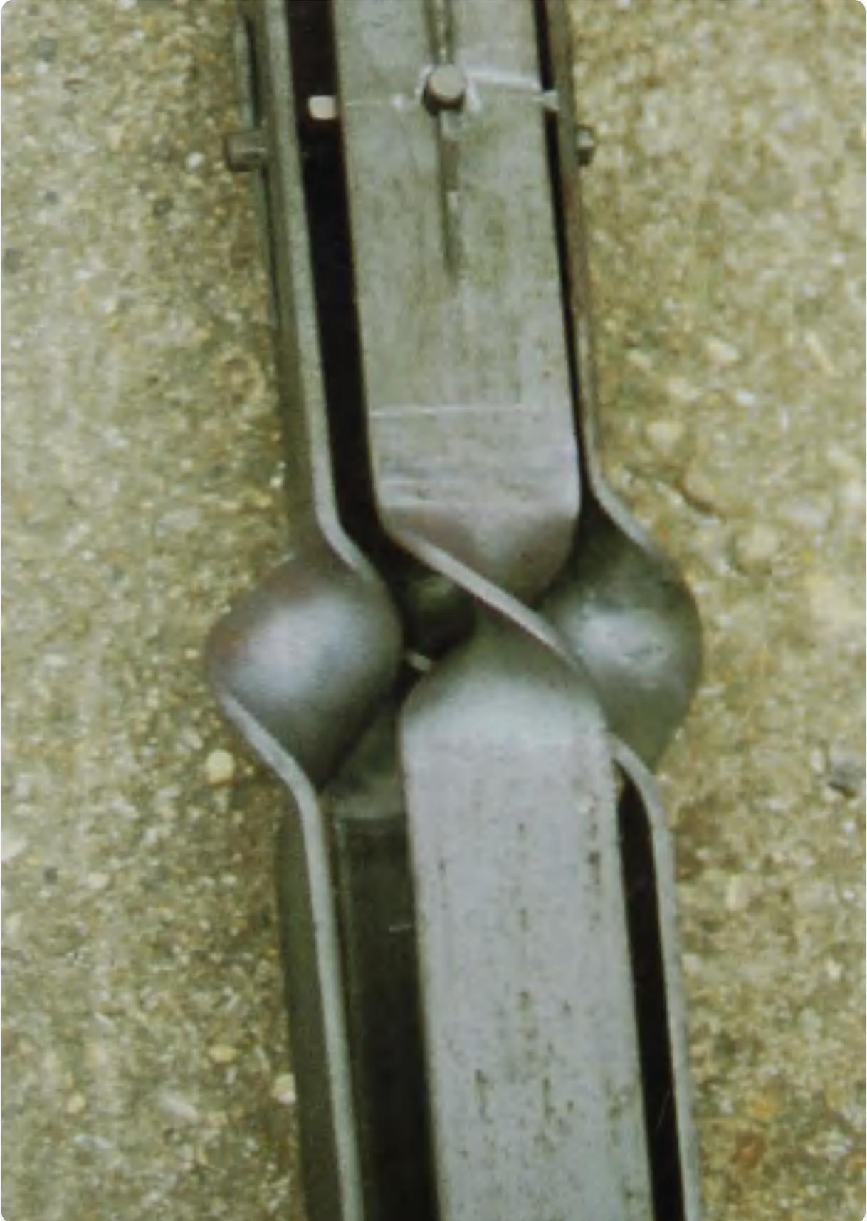
四根扭转的50mm(2英寸)扁钢条,在Alison Rew设计的落地灯的箱型截面柱中形成细节。
