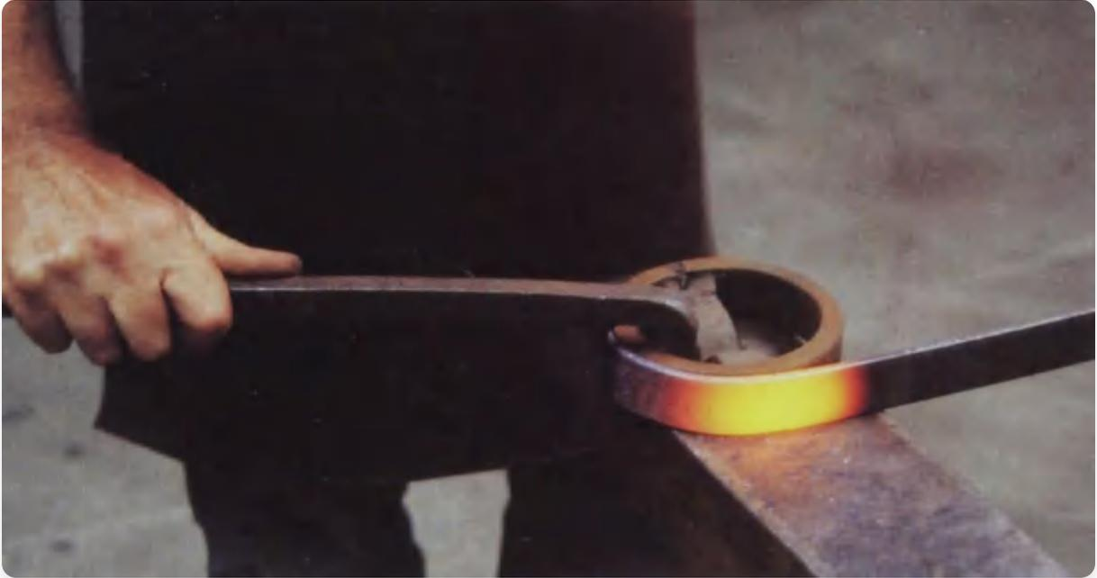
用螺旋扳手锁定钢条的一端，同时用手拉动另一端。
