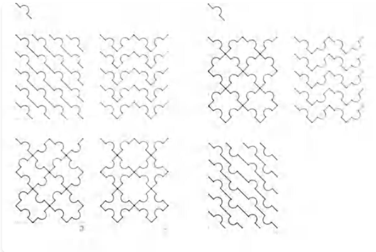
在网格上设计重复图案的示例。基本单元显示在左上方,图案区域显示了该单元的七种不同可能排列。这些图案是通过考虑所有可能的排列组合得出的,包括排成线、左右镜像、上下镜像以及围绕一个点旋转。这种策略可用于探索任何基本单元的图案可能性。
