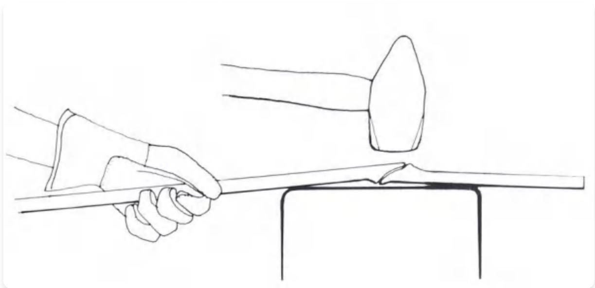
焊接对接接头。一个斜面压住另一个。注意下方的气隙,在锤子敲击之前防止金属在砧子上冷却。
