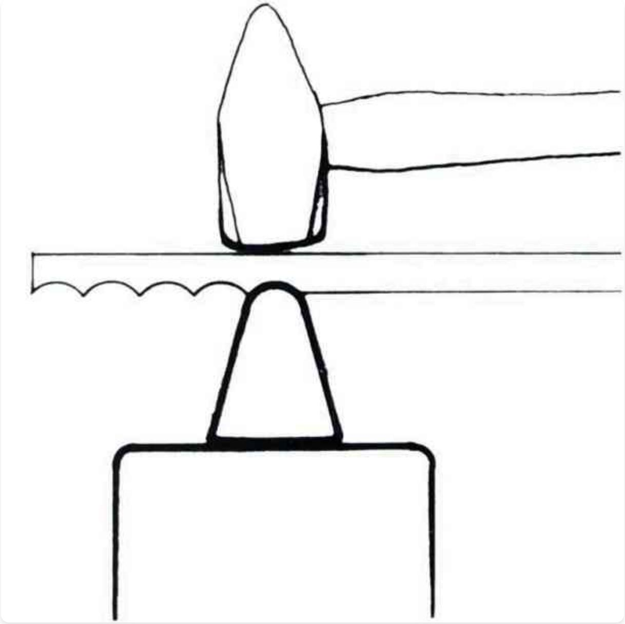
在圆凹模(fuller)上拉伸铁条。
