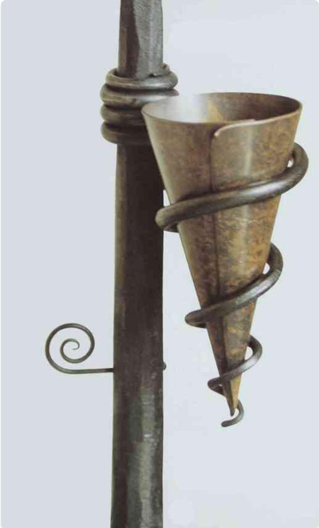
作者在吉尔福德大教堂制作的花架细节。使用开口锥形螺旋来固定铜制花瓶。小的扁平螺旋是一个夹子，用于固定致谢卡。
