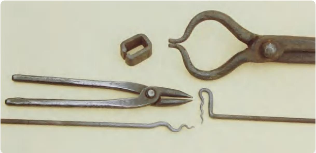
(上)用于打开和关闭套环的夹子钳,以及典型的扁钢条套环。(下)用于操作细钢条的圆头钳,带有典型的弯曲细节。
