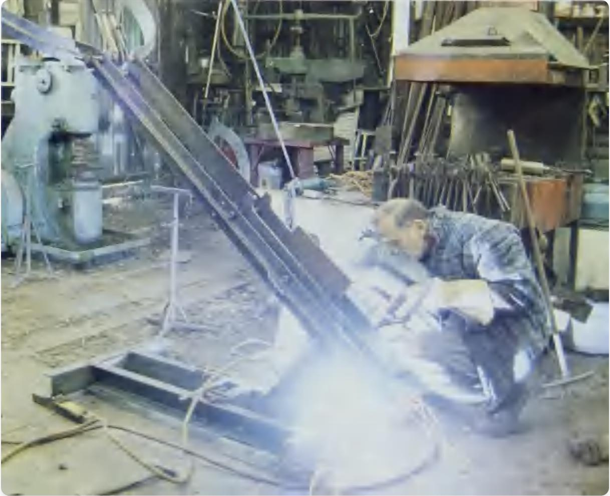
在车间里电弧焊接大型日晷(sundial)。
