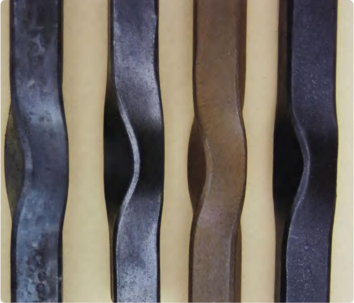
表面处理样品。(从左到右)加热后的氧化物表面;钢丝刷处理和上蜡后的氧化物表面;喷砂、生锈和上蜡后的杆材;喷砂、锌喷涂并用擦亮黑色石墨涂料面漆处理后的杆材。
