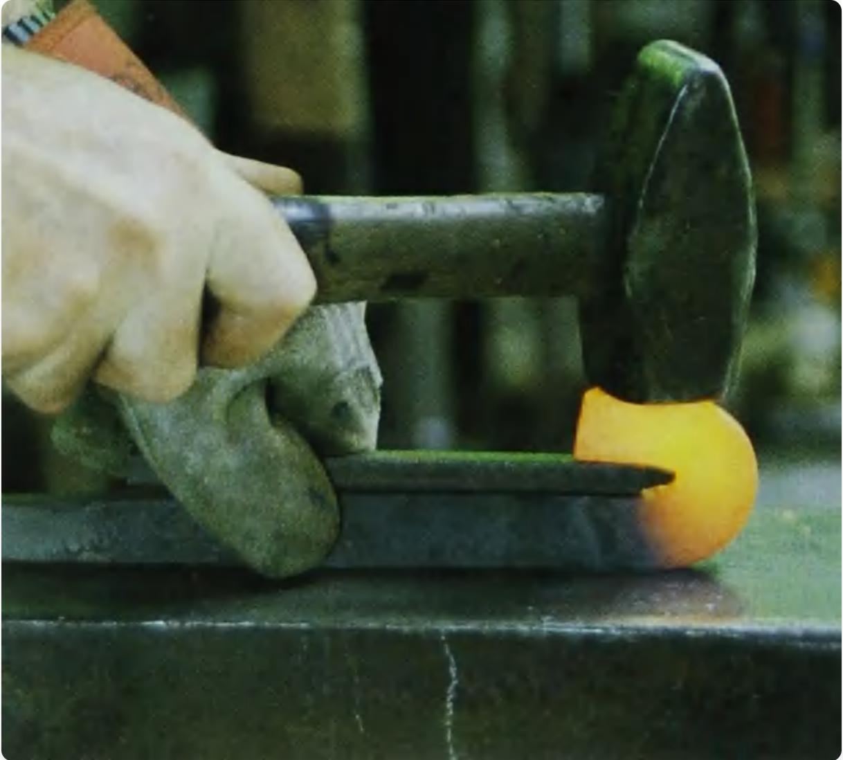
通过在填充件上折叠钢条来制作扭转扳手的末端。
