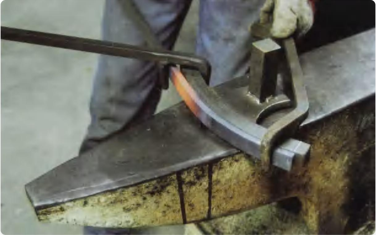
使用夹具在杆的末端制作短弯曲。注意用于定位杆端的粉笔标记。
