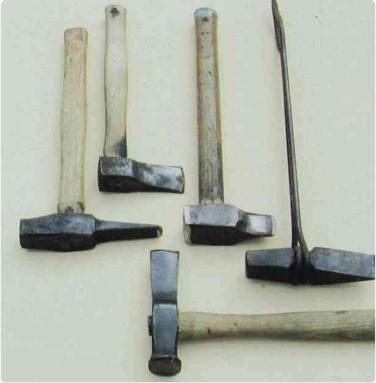
热切模。用于切割热金属的凿子。
