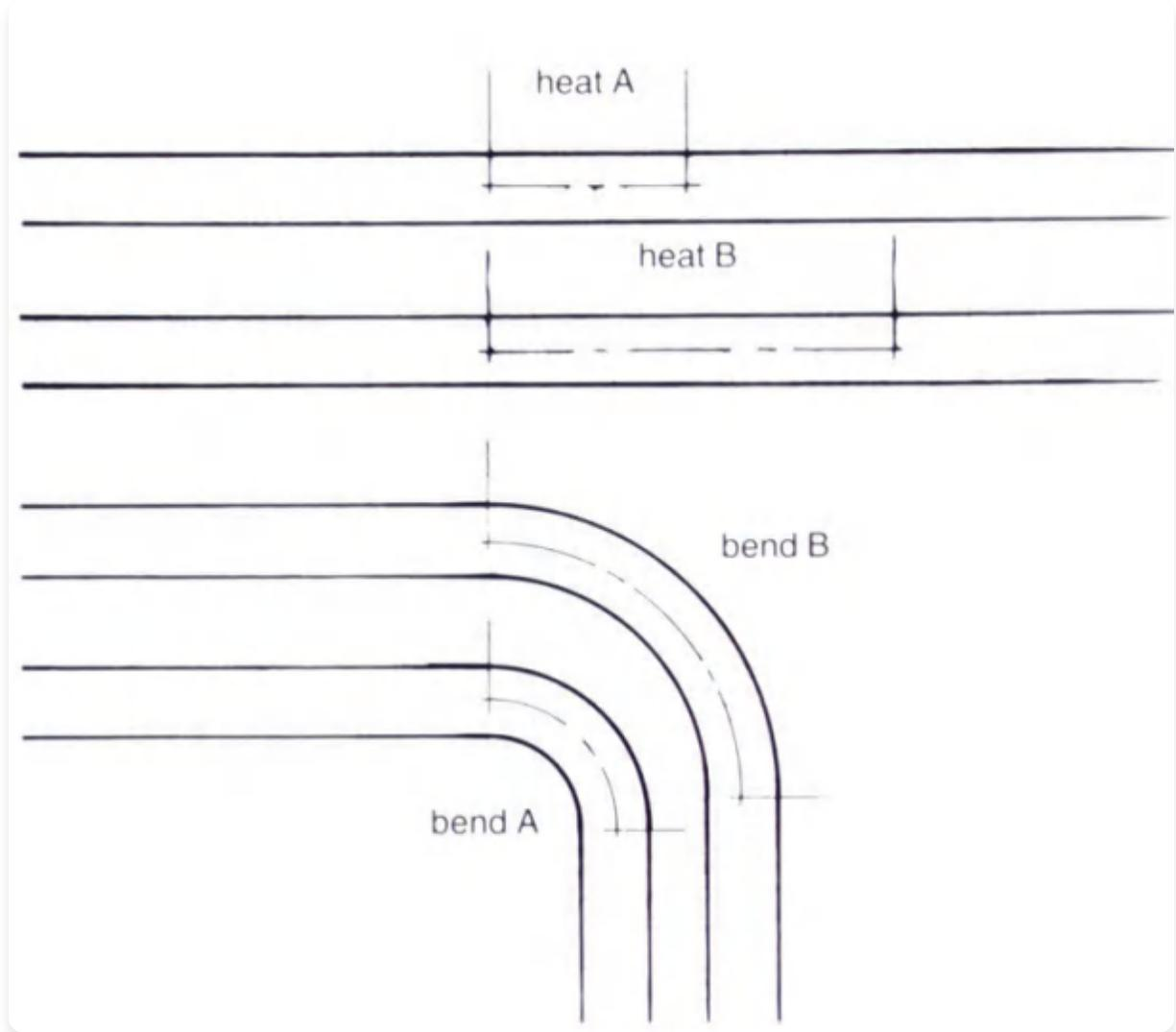
使用热量长度控制弯曲半径
