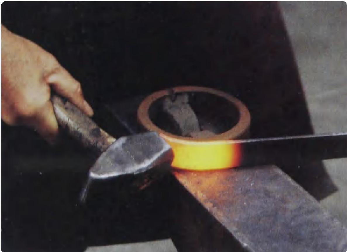
使用圆环弯曲夹具。将钢条的端部锤平，用定位在底模孔中的夹具开始制作圆环。
