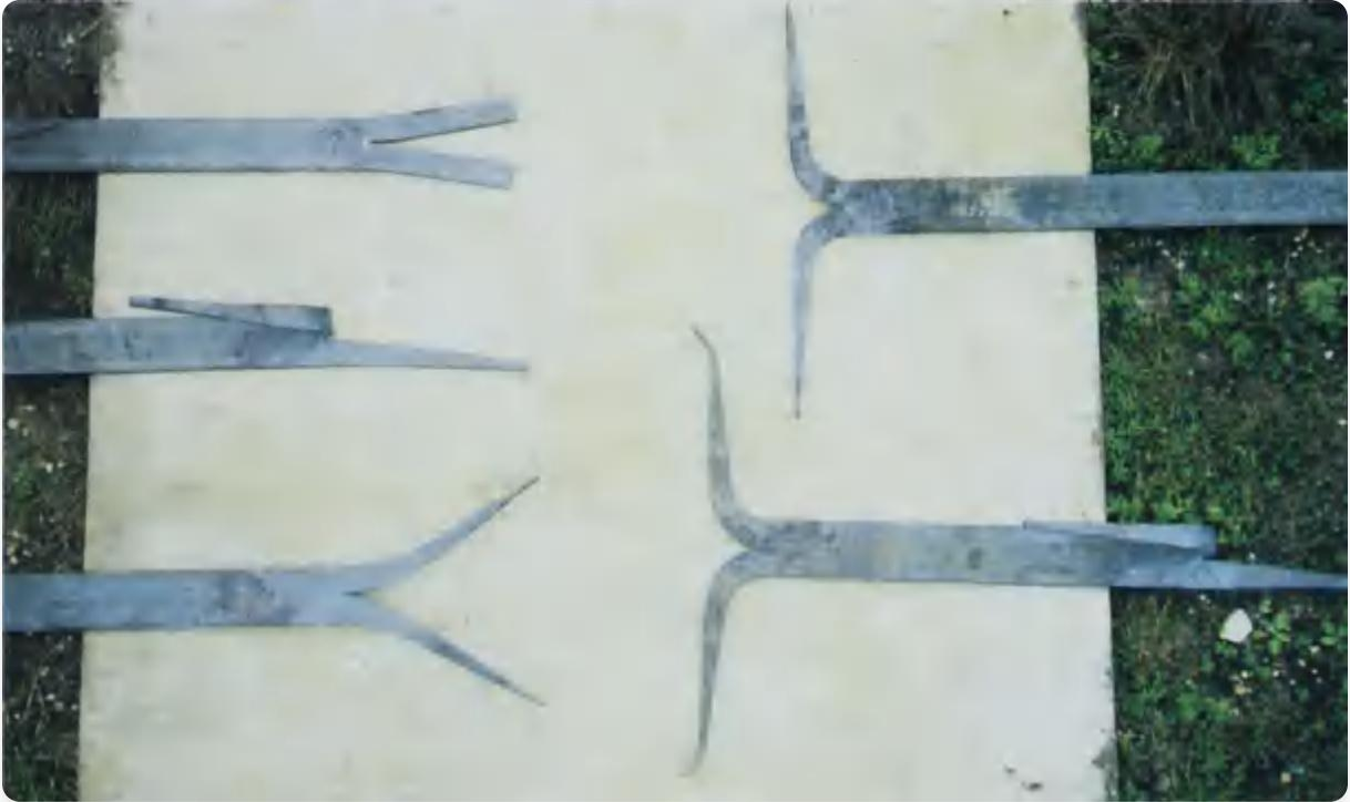
切割和锻造窗格栅部件的阶段。(从左上逆时针)棒材分割;一条腿折回以锥化另一条;两条腿锻造;腿锻造回直线;尖端弯曲。
