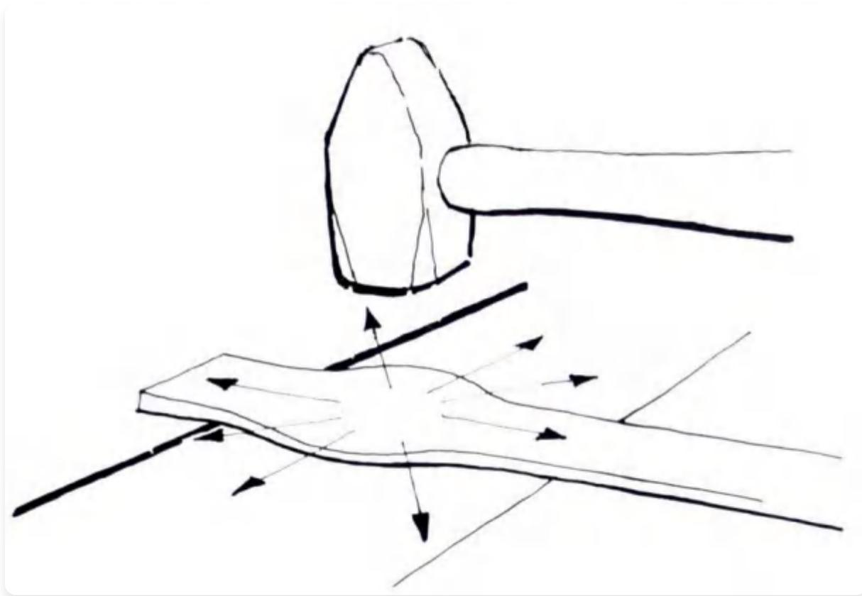
锤子的平面使金属向所有方向扩散。
