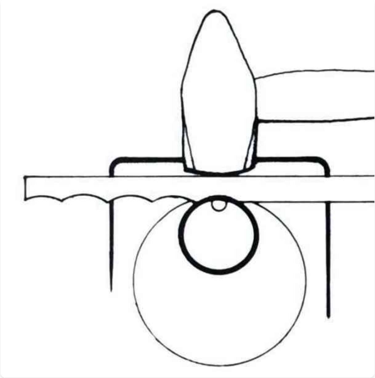
在铁砧的尖角(bick)上拉伸铁条。
