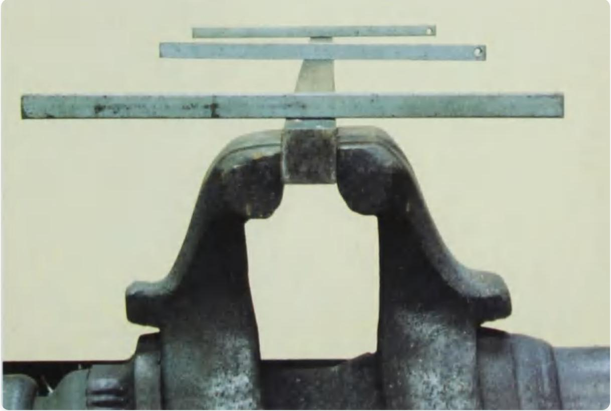
使用矫正杆检查铁条的扭转。
