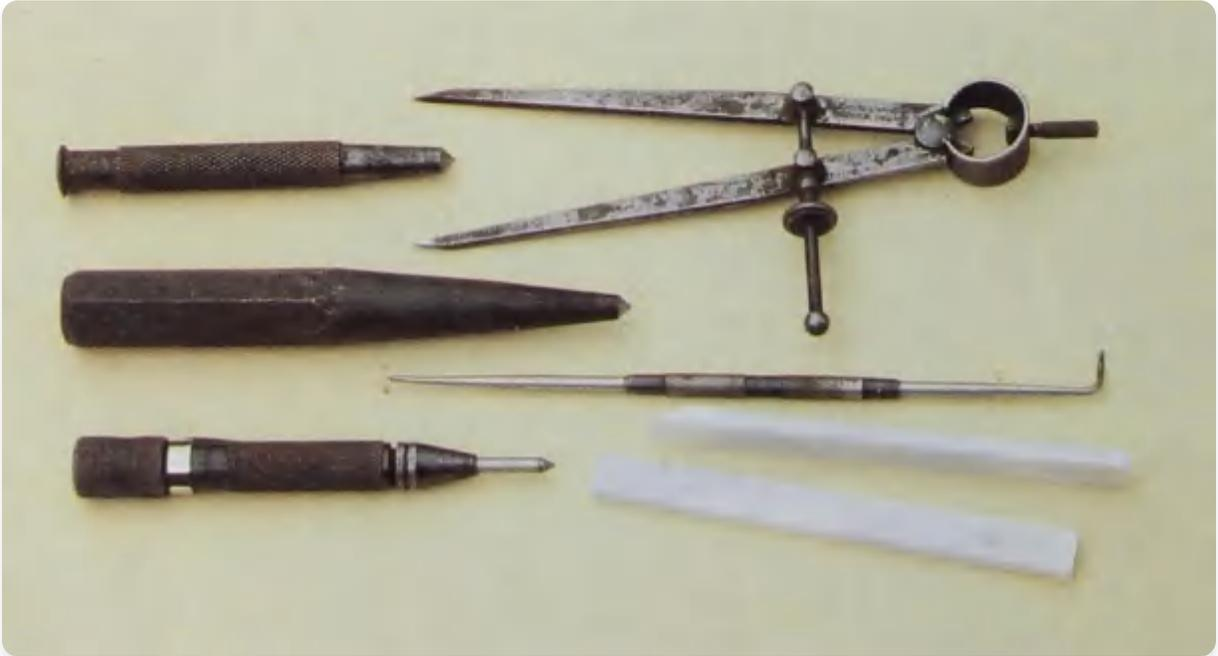
划线工具:中心冲、圆规、划针、法国粉笔。
