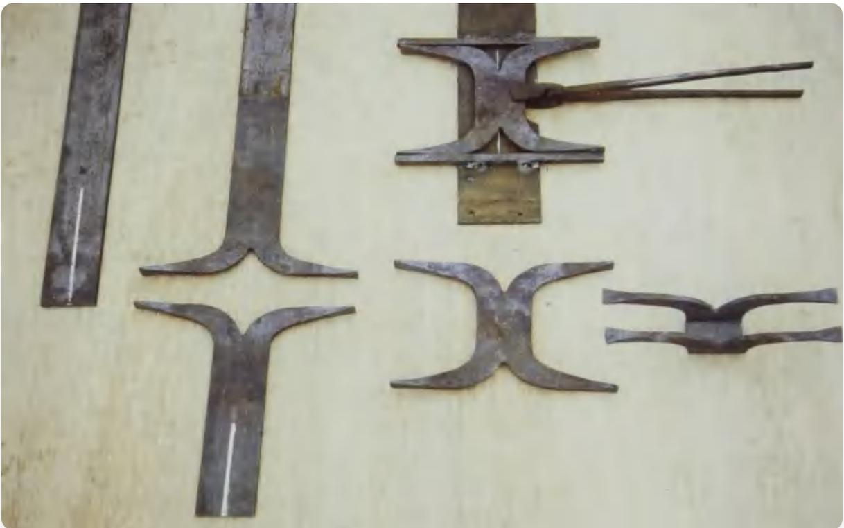
锻造同一格栅单元的阶段。(从左到右)标记切口;一端分割和锻造,并从棒材上切下;两端锻造并在夹具中检查尺寸和对齐;在飞压机工具中将锻件弯曲成“U”形。
