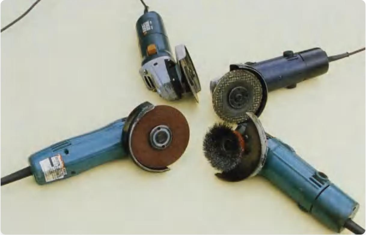
角磨机，配有不同的磨片。（从左上角顺时针）切割片、打磨片、钢丝刷和砂纸片
