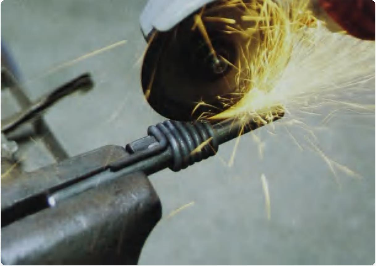
用1毫米厚的切割片切开缠绕的圈。
