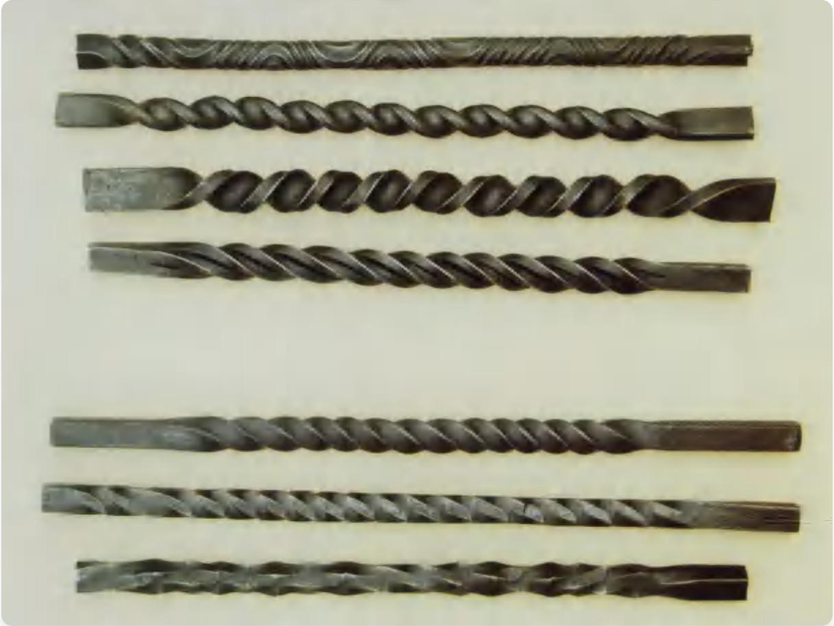
扭转样品。(从上到下)在方形钢条上锻造八个边并反向扭转;圆边扁钢条扭转;扁钢条扭转;用凿子切割并扭转的方形钢条;方形钢条上的普通扭转;扭转的钢条重新锻造成方形;钢条重新扭转。
