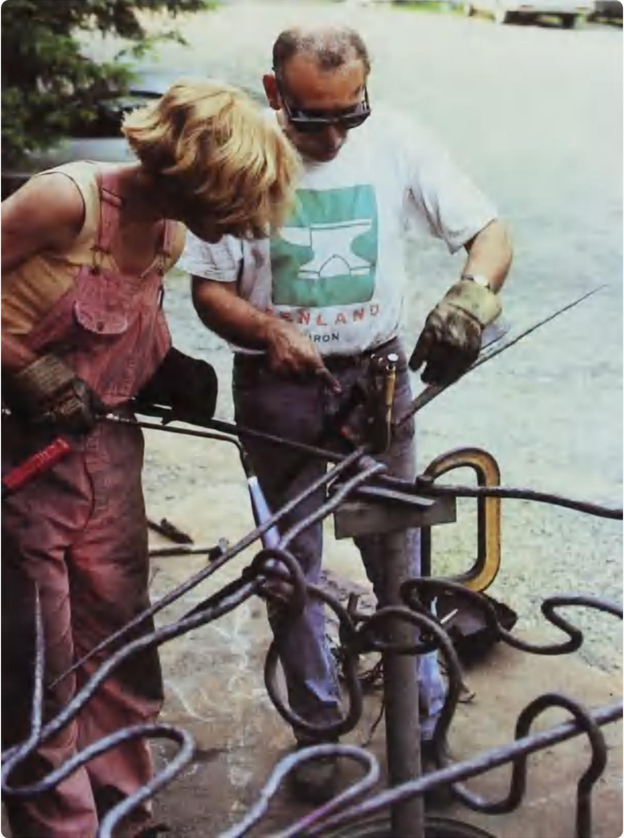
在圆钢条上制作缠绕接头,用于制作床头。
