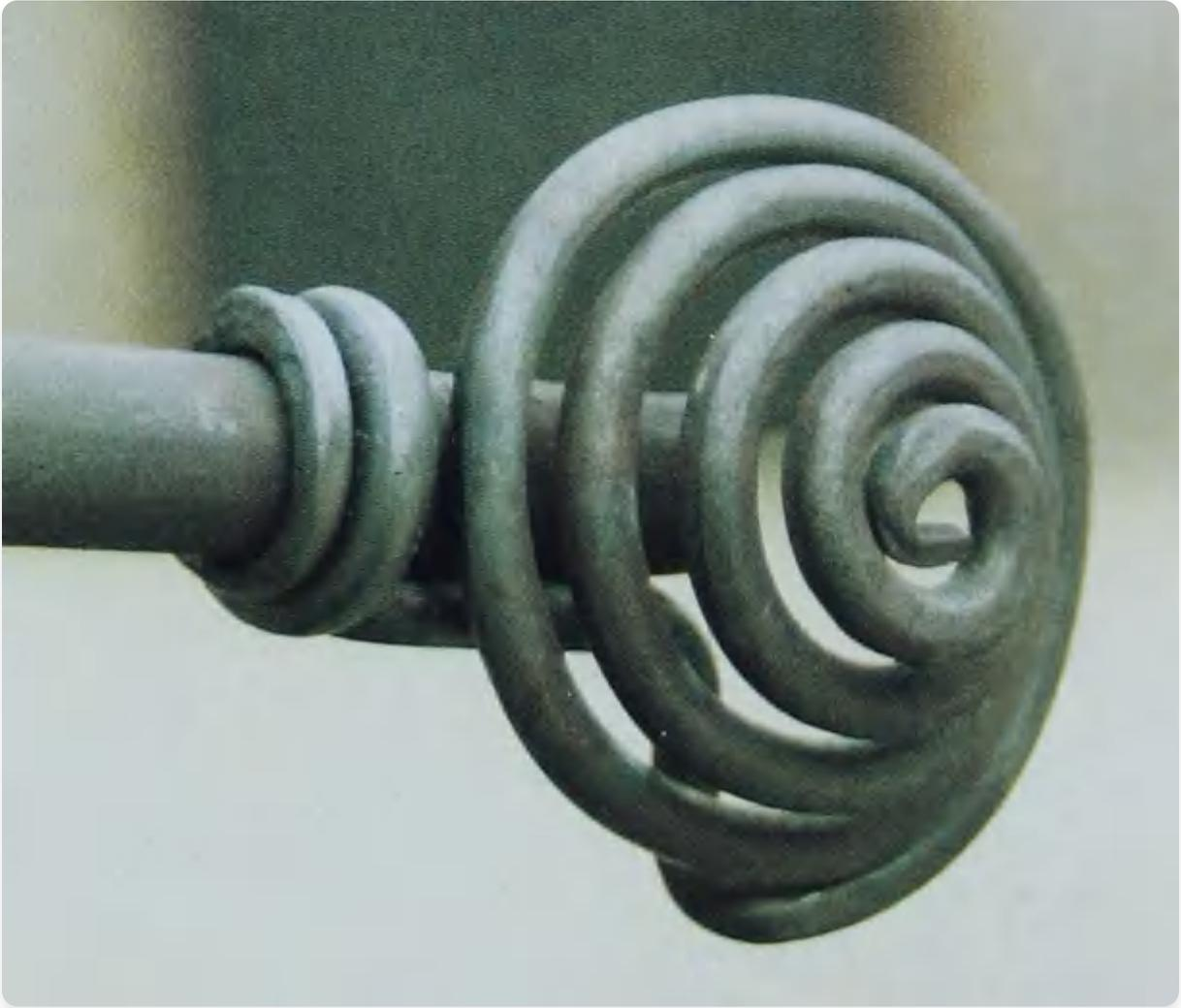
Miranda Souter制作的窗帘杆顶饰。通过压制平面螺旋制成的锥形螺旋。
