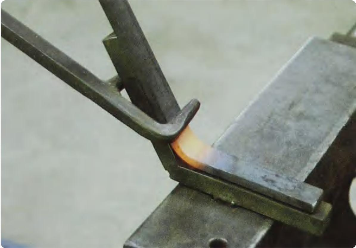
使用制作的弯曲夹具来获得特定角度。
