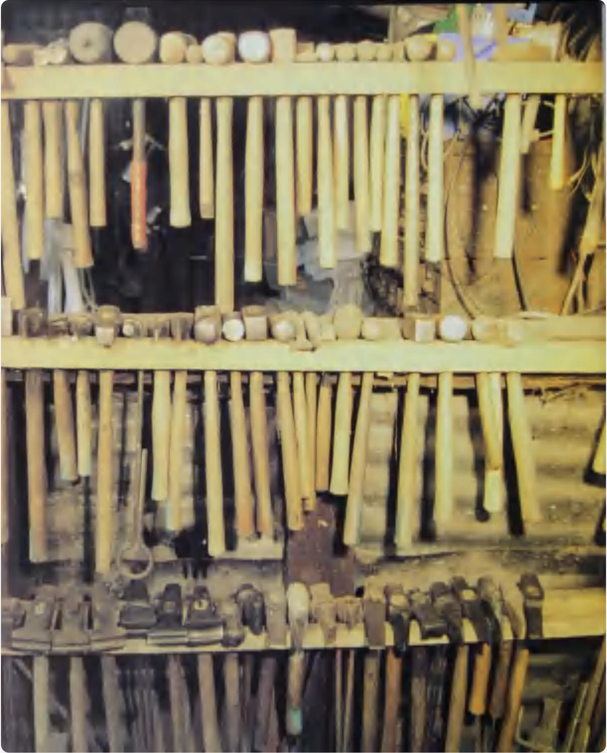
[锤子、压模、热鍍子和冲头的工具架。]
