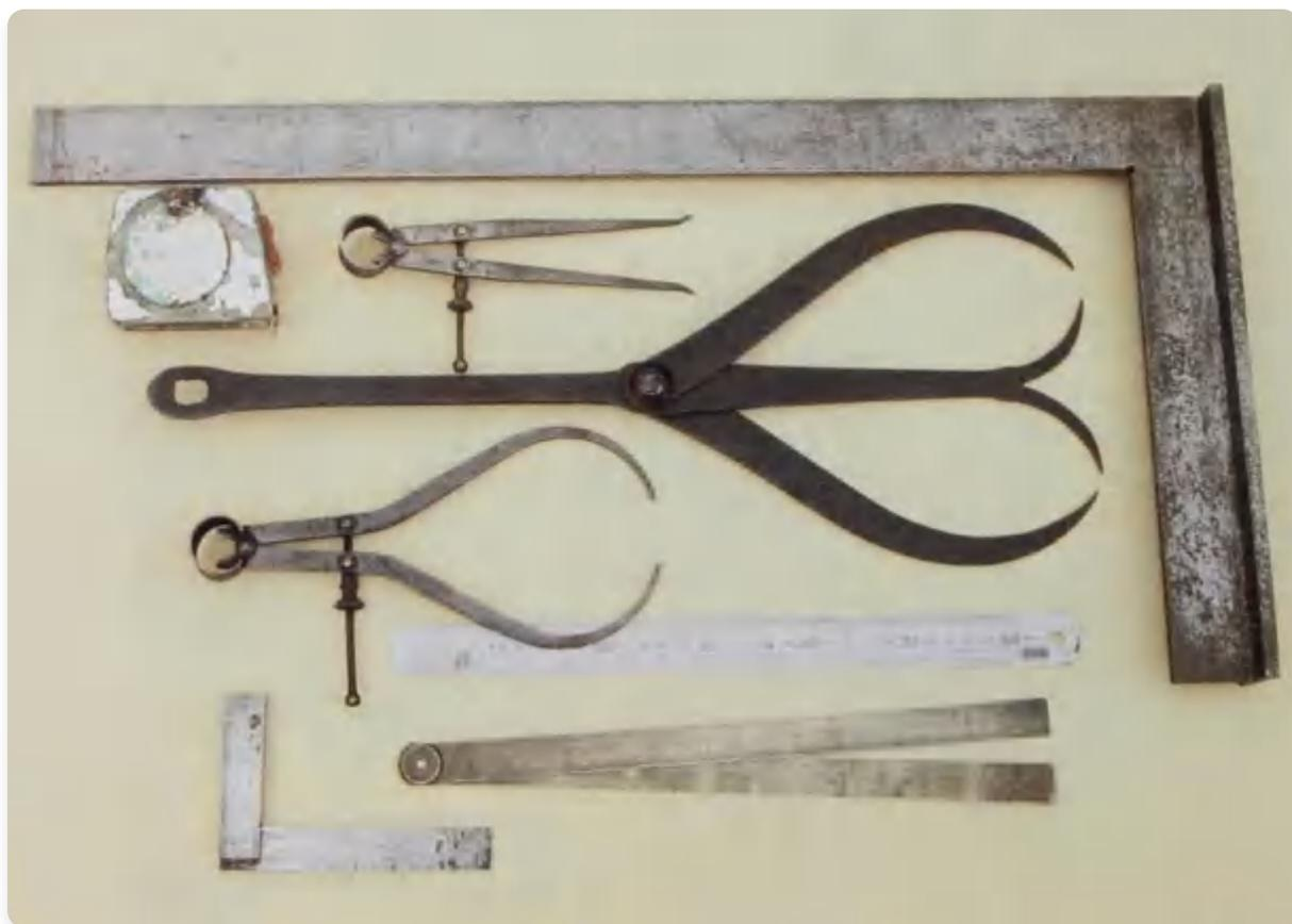
测量工具:(从上到下)大型工程师角尺、钢卷尺、弹簧内卡尺、铁匠双头卡尺、弹簧外卡尺、缎面镀铬钢直尺、黄铜折叠尺、小型工程师角尺。
