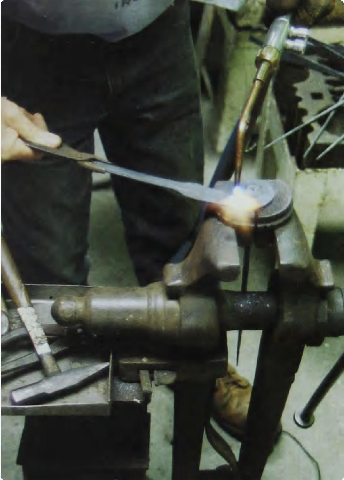
在台钳夹具中拉圆螺旋。如果扁平棒材弯曲,需要一个平面来压平。
