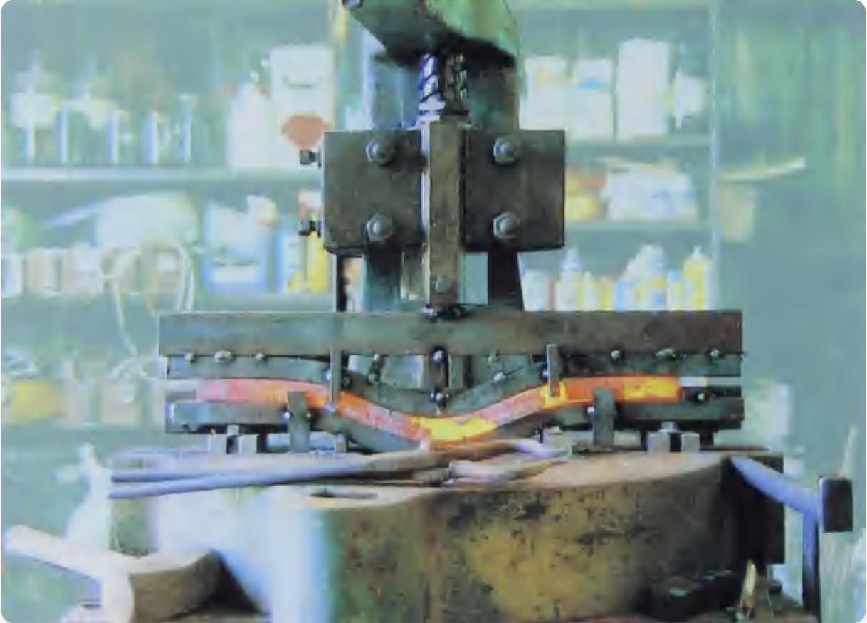
在大型飞轮压力机下一次操作完成复杂弯曲。为了实现这一点，必须有一个能够加热约700mm（2英尺3英寸）金属的燃气锻炉。通过这种方式，一个上午可以弯曲七十二根钢条。
