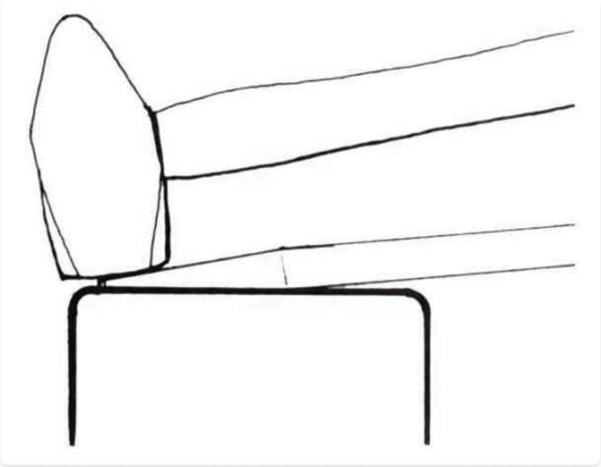
将锥度末端定位在砧边缘，使锤子能够锻造尖端。
