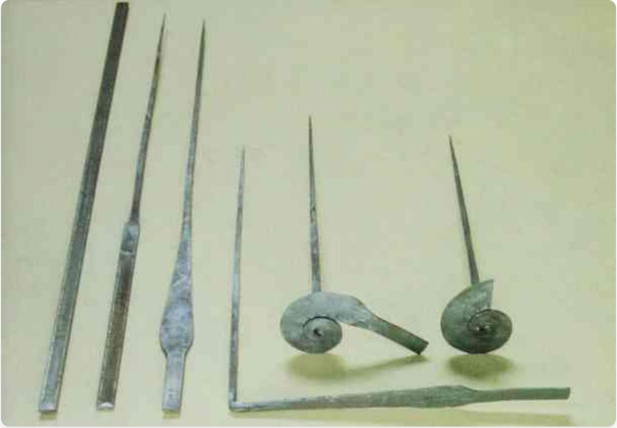
平面螺旋烛台的制作过程。
