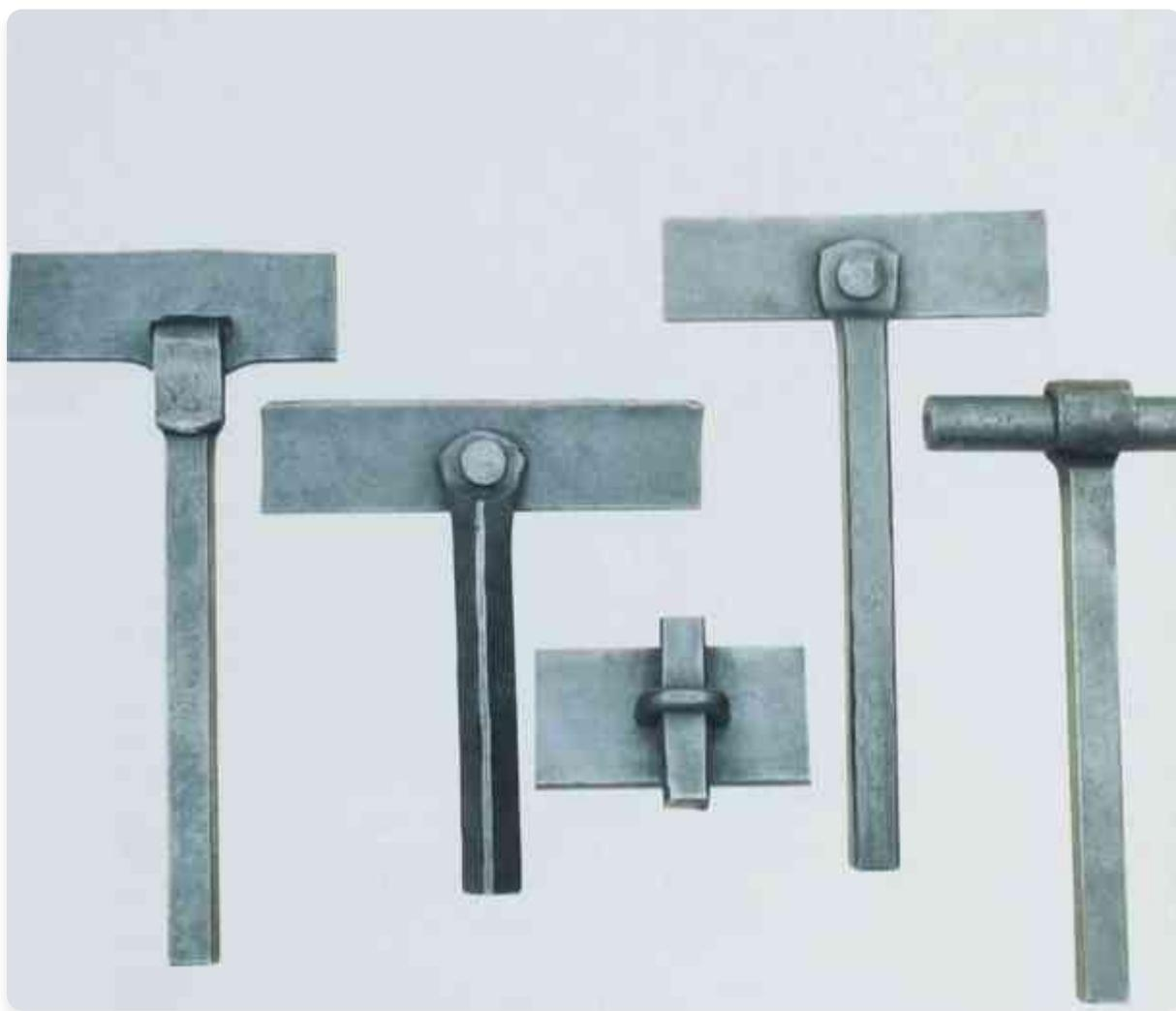
接头样品,显示横杆和立柱之间的不同连接方式。
