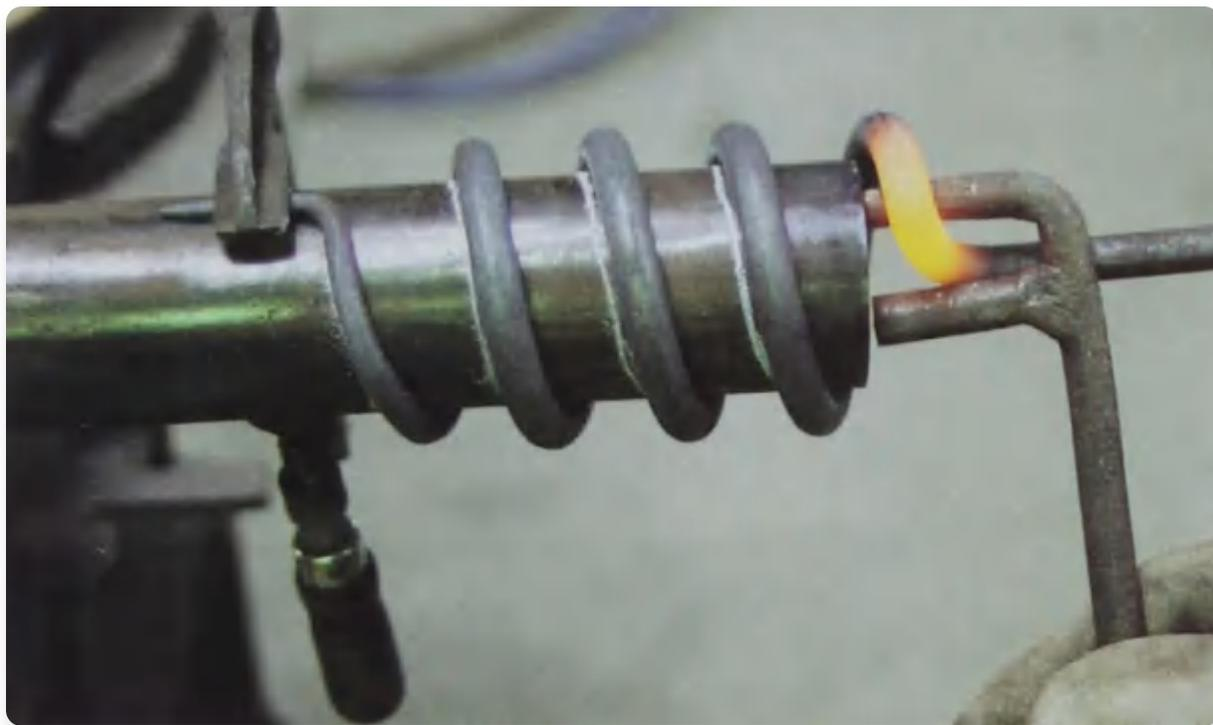
使用芯轴，用粉笔标记以布置开放式螺旋。端部正在用螺旋扳手弯曲，以将其放置在螺旋的中心线上。
