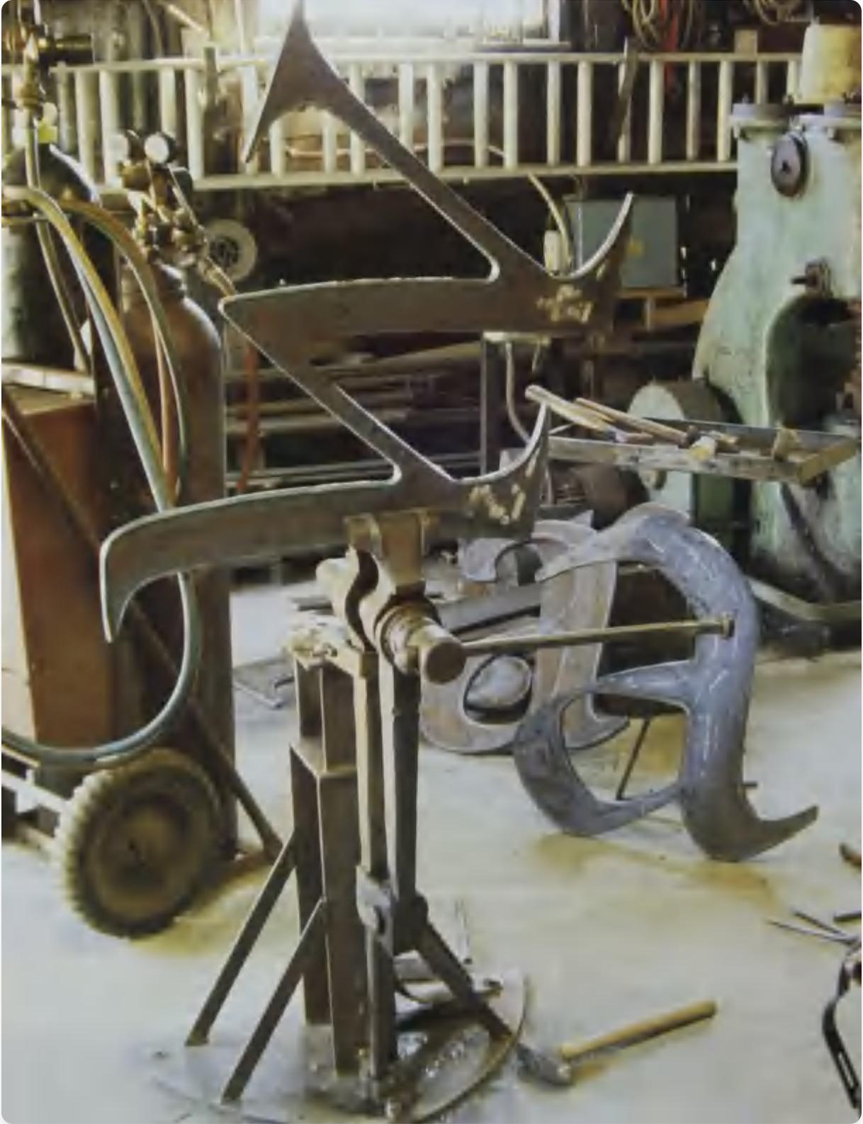
16mm钢板字母形状，由型材切割公司根据作者的图纸制作。字母的边缘用焊枪加热并全面锤击，形成凸缘(lip)，产生阴影和高光效果。
