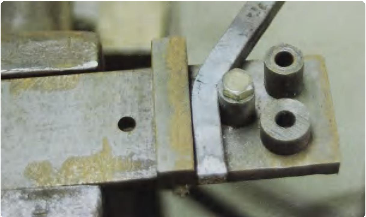
一个类似的弯曲工具,但中心销钉通过槽螺栓固定,以便更换中心销钉。图中显示了另外两个中心销钉。
