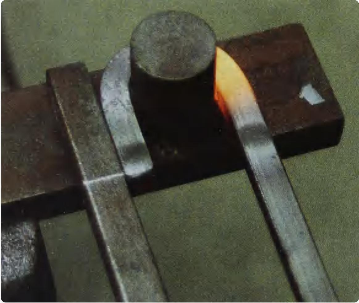
一个简单的弯曲工具,由零碎材料拼接而成。圆柱形销钉决定了弯曲半径。左侧的杆提供了一个刚性挡板,可以在不同位置用粉笔记以获得不同的弯曲长度。
