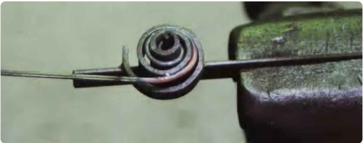
不断增长的螺旋在工具中下降，与下面的圈啮合。
