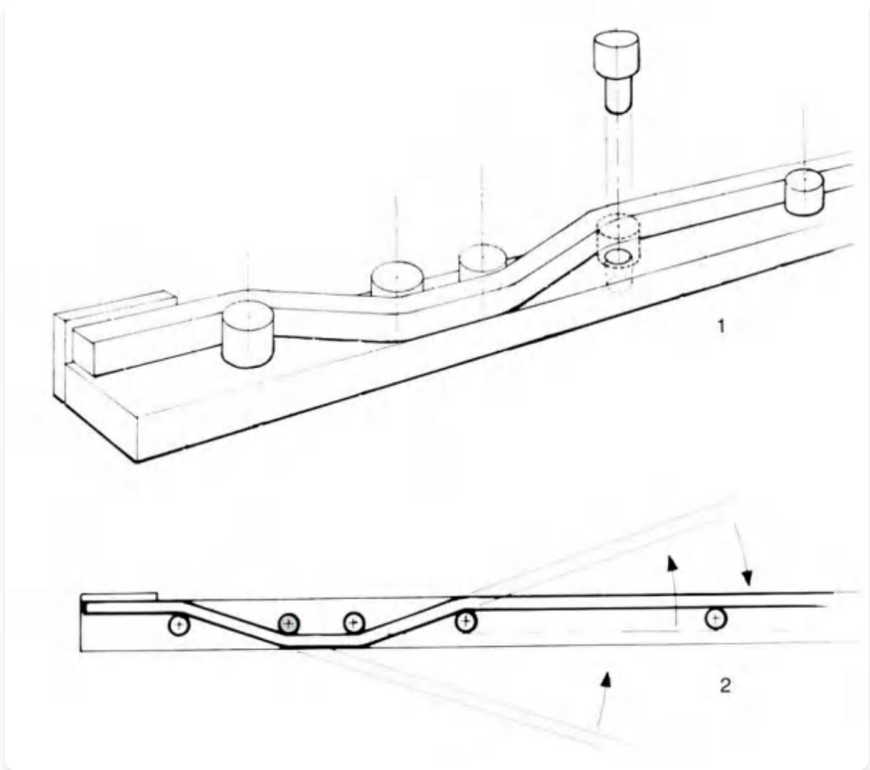
带有可拆卸零件的弯曲夹具,这些零件是定位在孔中的销钉。1)正在使用的夹具,显示移除了一个松动销钉 2)夹具平面图,显示如何插入杆、弯曲杆以及在弯曲过程中依次插入销钉。
