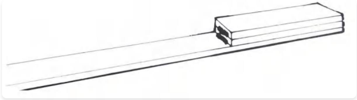
准备火焊的三层,用于制作花纹焊接钢。
