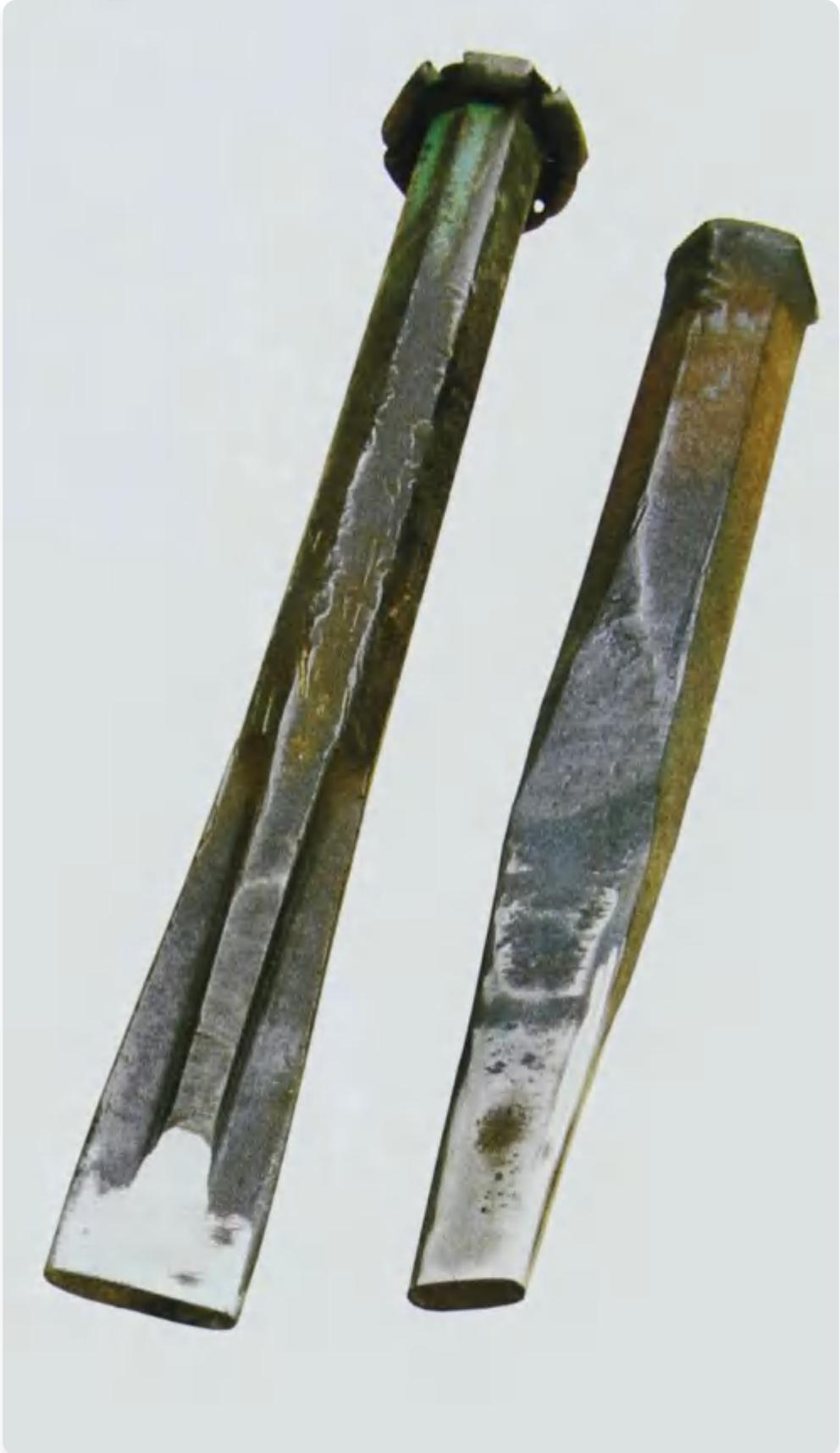
手持槽冲头,一个由建筑工人的星形钻改制而成。
